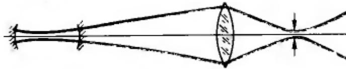
Рис. 6.3. Преобразование гауссова пучка света линзой
