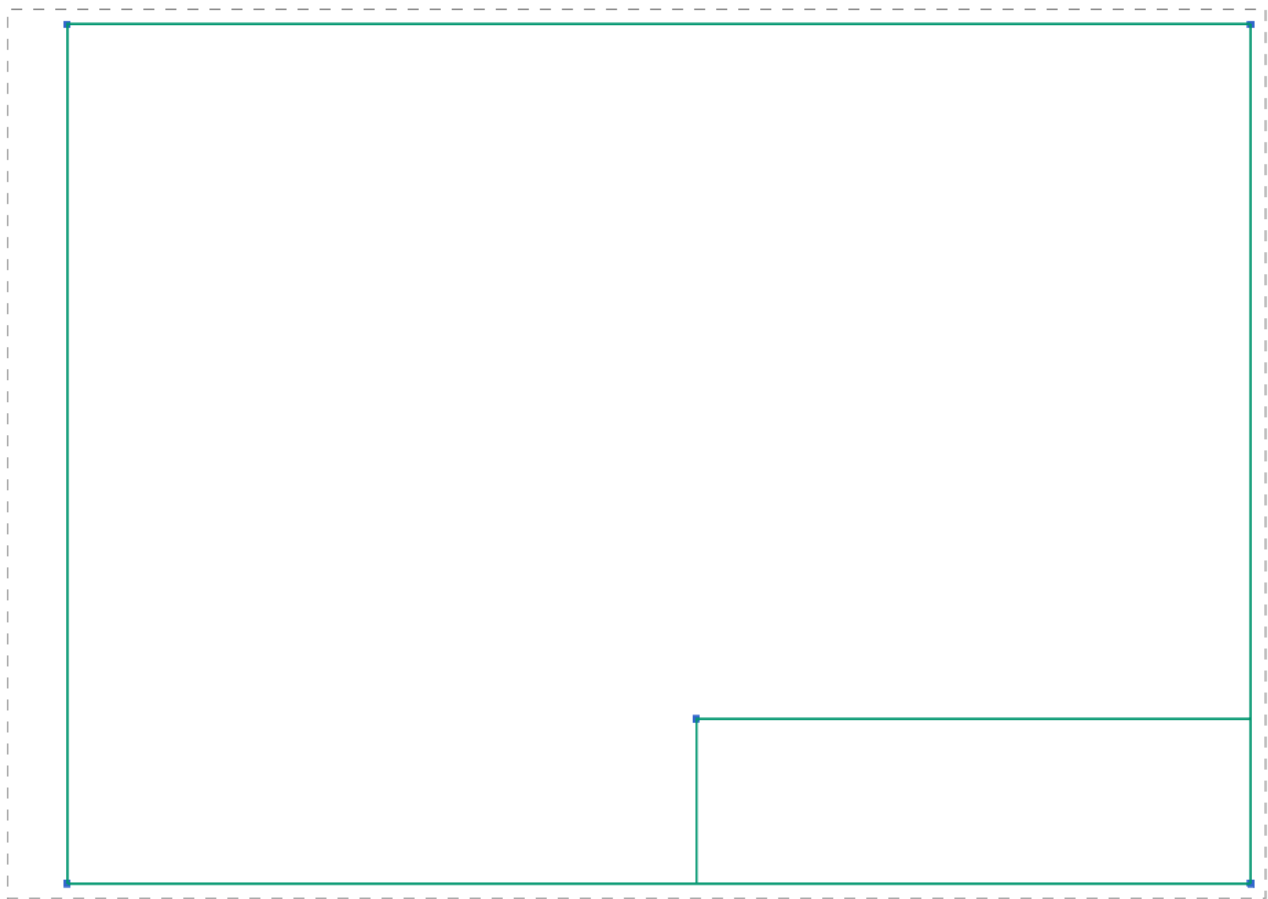
Рисунок 65 - Рамка основной надписи чертежа
