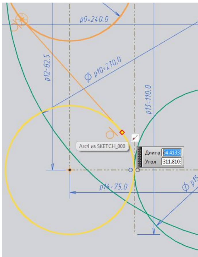
Рисунок 97 – Построение касательной линии к двум окружностям
