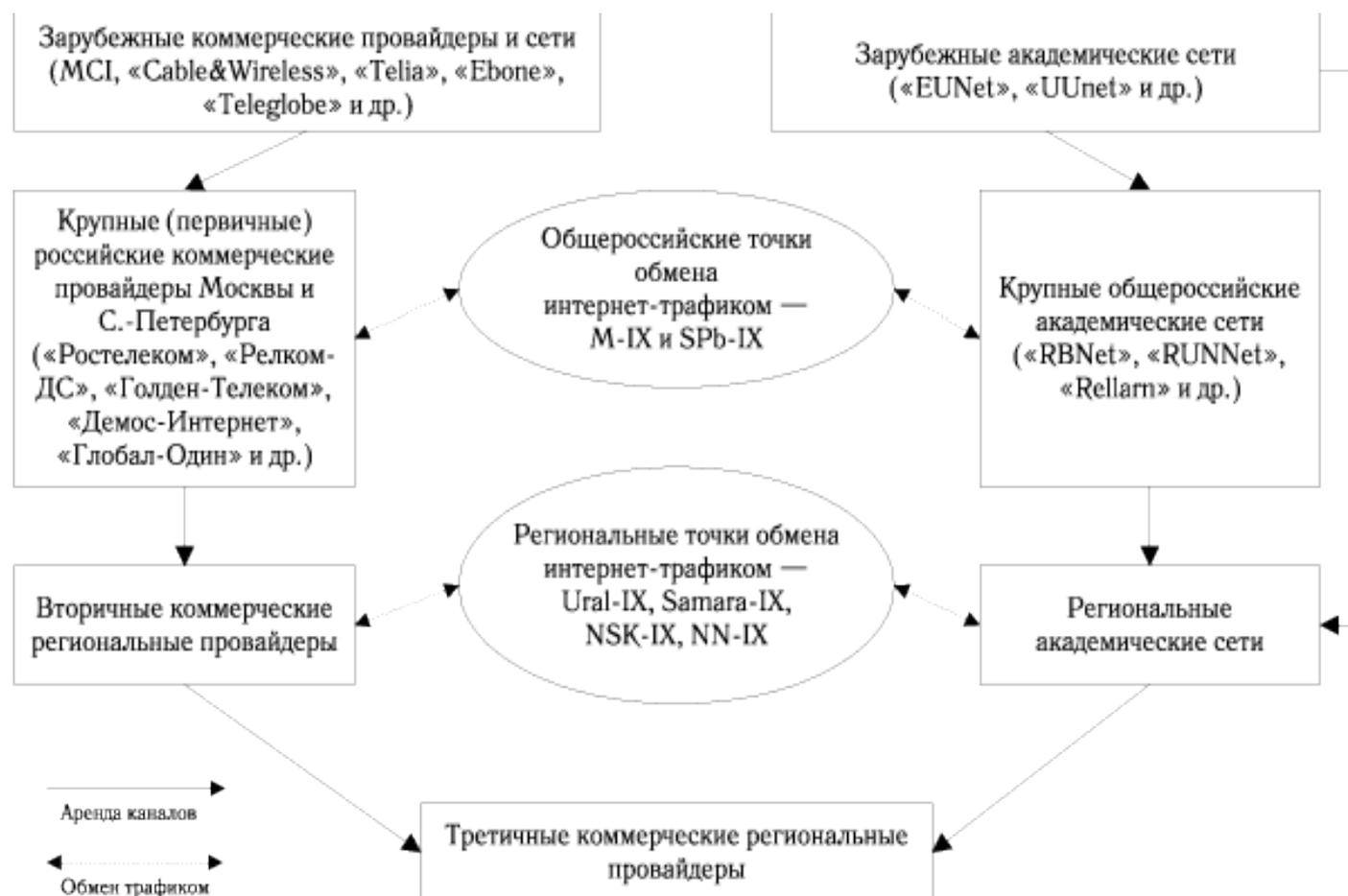
Рис. 4 Общая схема каналов передачи интернет-трафика на территории России
