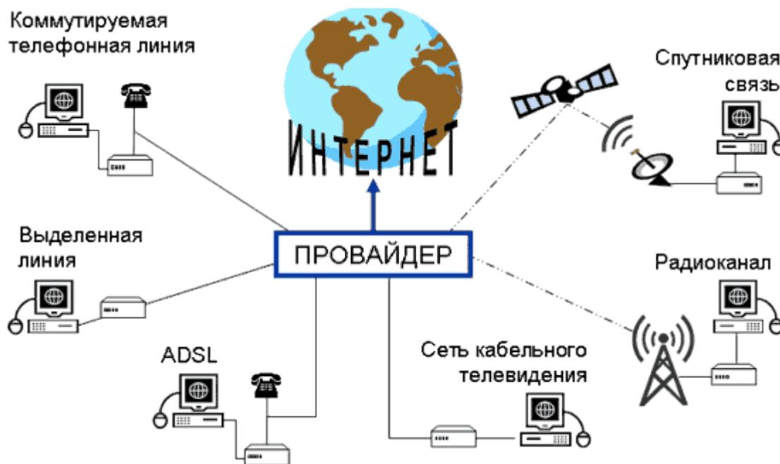
Рис. 10 Способы подключения к провайдеру.
