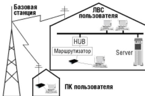
Рис.14 Доступ в Интернет по радиоканалу
