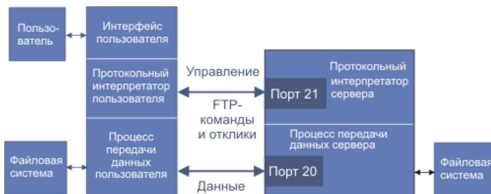
Рис. 19 Схема работы протокола ftp.
