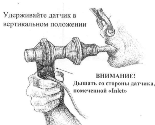
Рис.10. Схема положения датчика для процедуры калибровки.
