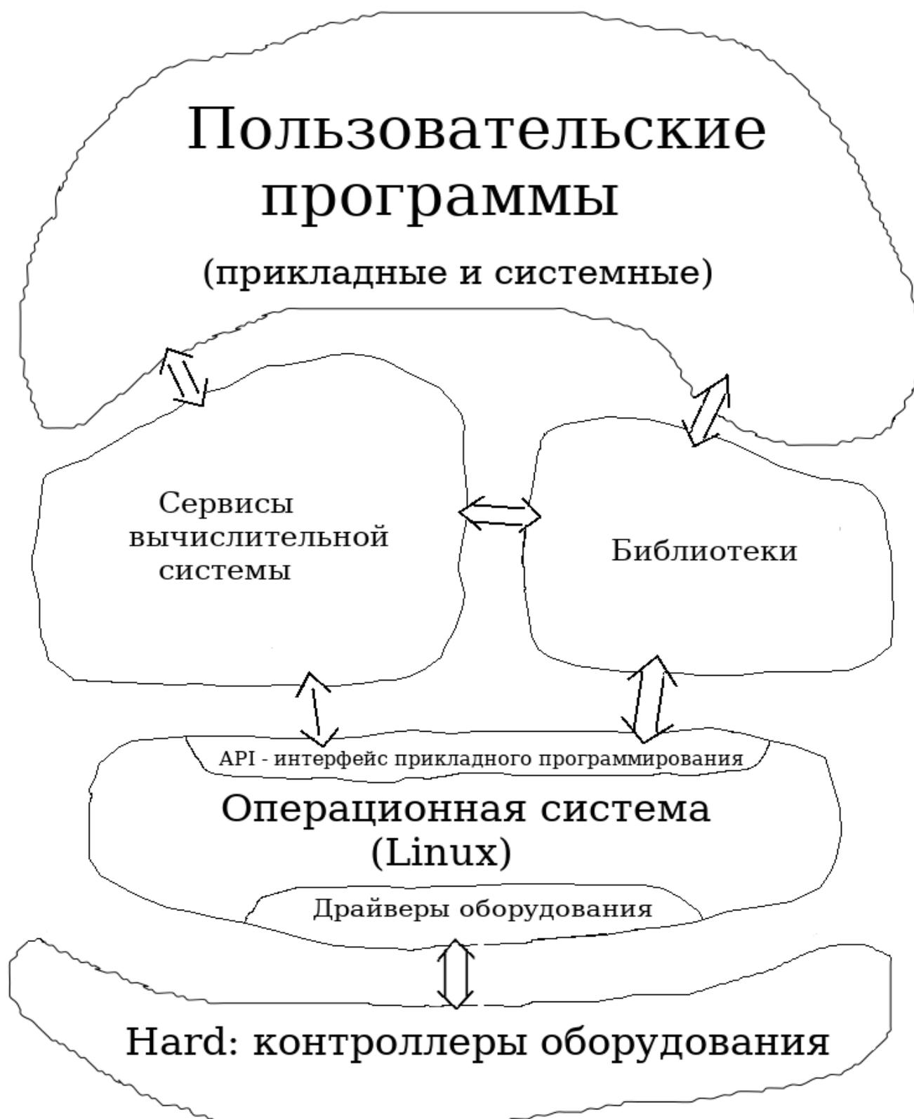
Рис. 1. Состав вычислительной системы
