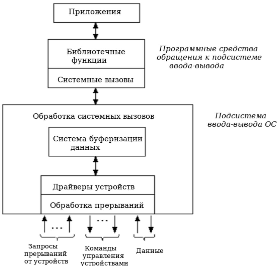
Рис. 19. Уровни программного обеспечения ввода/вывода
