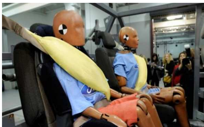
Рис. 3.7. Ремни безопасности со встроенными надувными элементами в момент срабатывания пиропатронов при испытании системы
