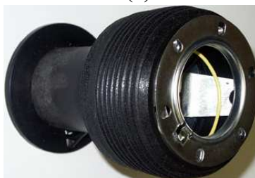
Рис. 3.20. Травмобезопасная проставка под рулевое колесо (сильфон)
