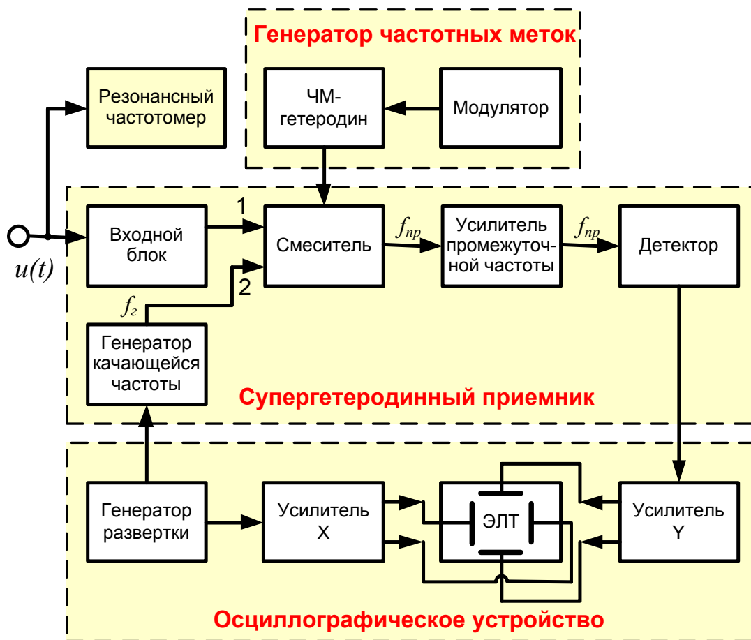
Рис. 11.3. Структурная схема анализатора спектра последовательного типа.
