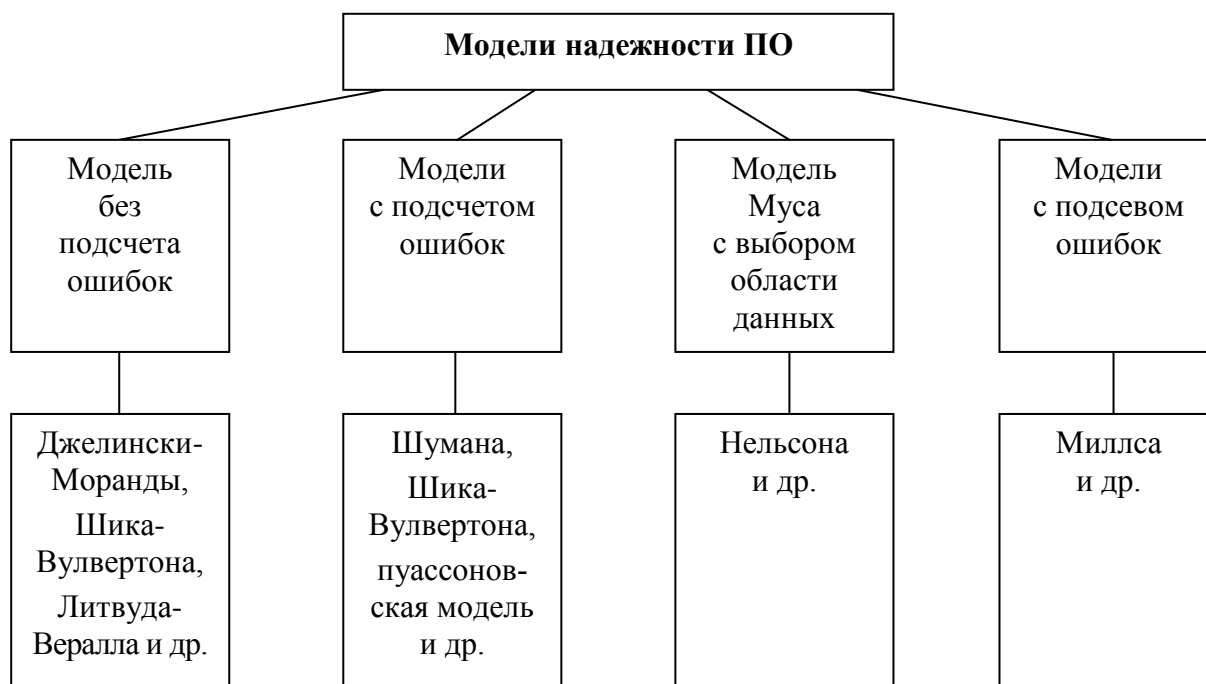
Рис. 31. Типы моделей надежности ПО по Гоэлу
