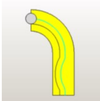
Рис. 1.6. Траектория без наклона инструмента (вид сверху)
