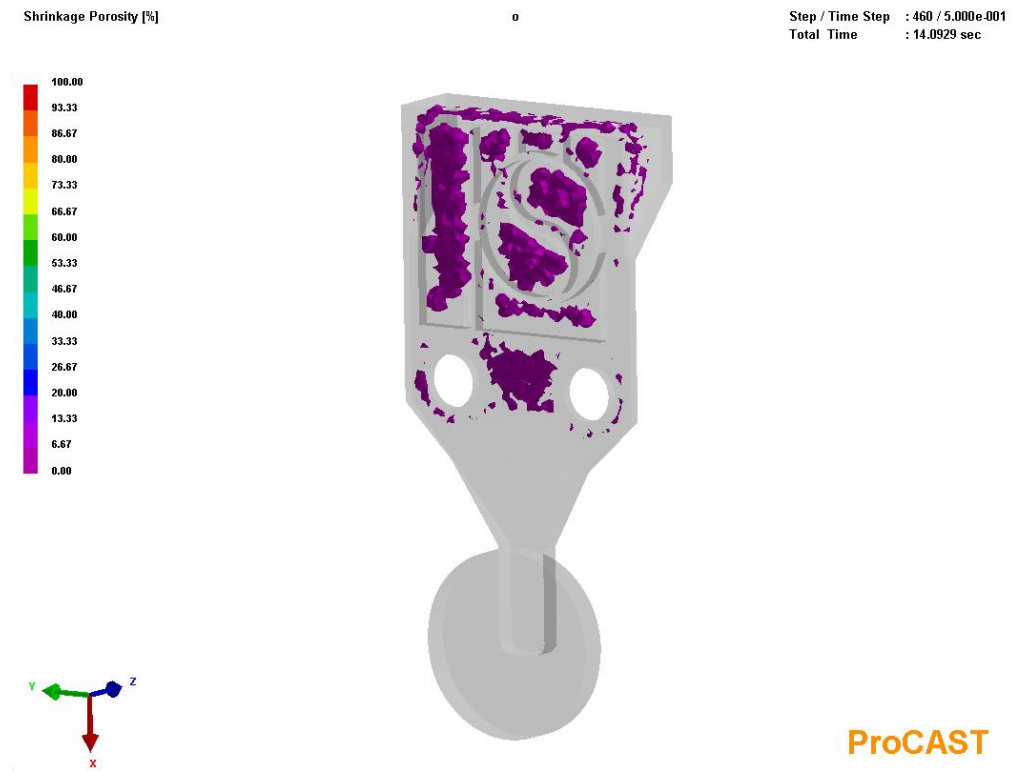
Образование усадочной пористости
