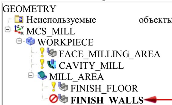
Эти шаги изменяют параметры так, чтобы операция использовалась для чистовой обработки стенок. Для избегания касания инструментом пола и исключения отклонения инструмента задается очень малый припуск по полу:
