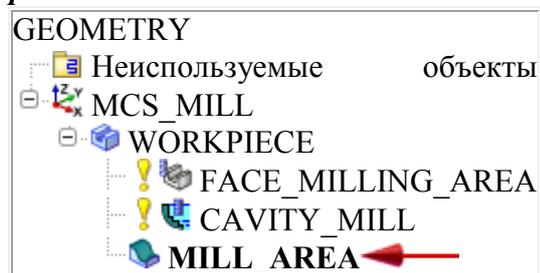
Группа геометрии MILL\_AREA задает два кармана в качестве области резания для черновой и чистовой обработки карманов.
