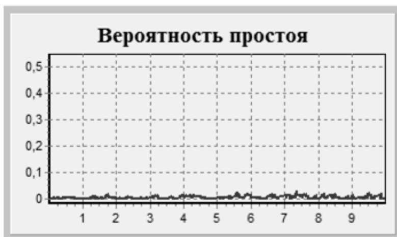
Рис.4. Вероятность простоя системы с параметрами: T = 10 , N = 15 , \Delta = 0,001 , \lambda_1 = 5 , \lambda_2 = 4 , \mu_1 = 4 , \mu_2 = 3 , n = 3 .
