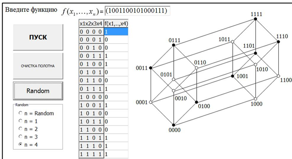
Рис. 3. Пример представления булевой функции четырёх переменных графическим способом.
