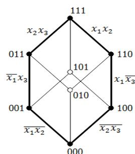
**Рис. 9.** Сокращённая ДНФ для функции  $f(x_1, x_2, x_3) = (11011011)$ .
