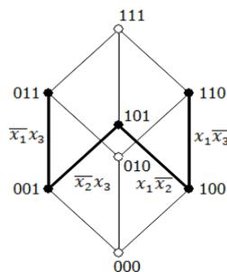
**Рис. 8.** Сокращённая ДНФ для функции  $f(x_1, x_2, x_3) = (01011110)$ .
