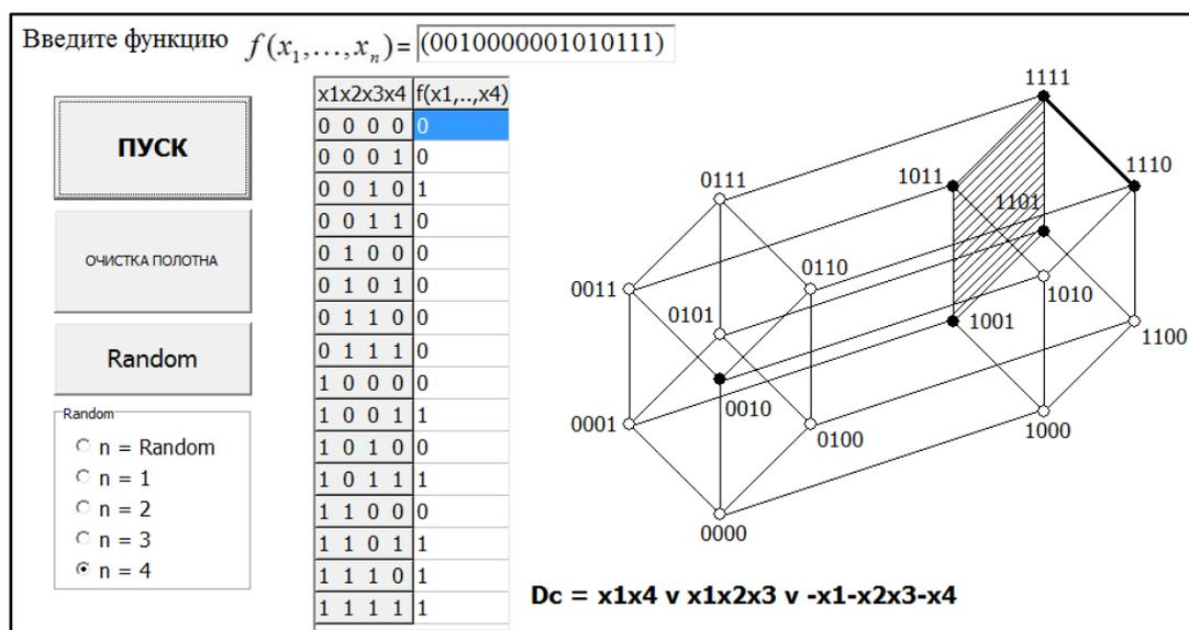
Рис. 10. Пример построения сокращённой ДНФ булевой функции четырёх переменных.
