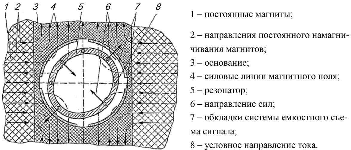
Рис. 1. Преобразователь давления в разрезе
