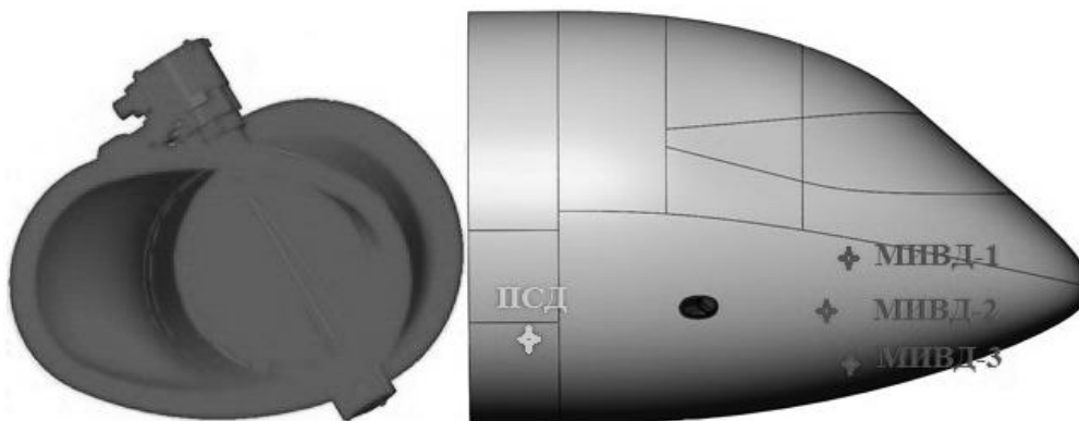
Рис. 1 – Внешний вид клапана САРД (слева), его расположение на фюзеляже самолета и места установки приемников (справа)
