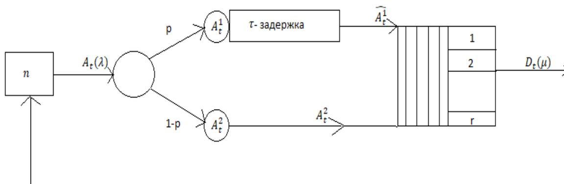
Рис.1. Схема СМО с ограниченным источником заявок и задержкой в обслуживании.
