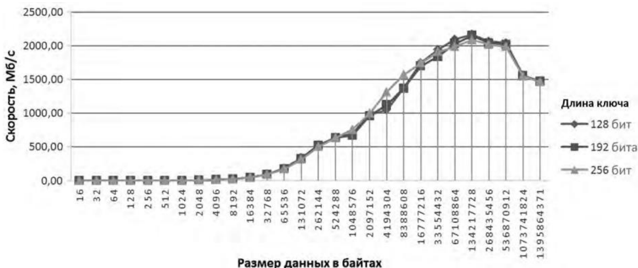
Рисунок 13 — Скоростные показатели шифрования данных объемом от 16 байт до 1 Гб с использованием видеокарты
