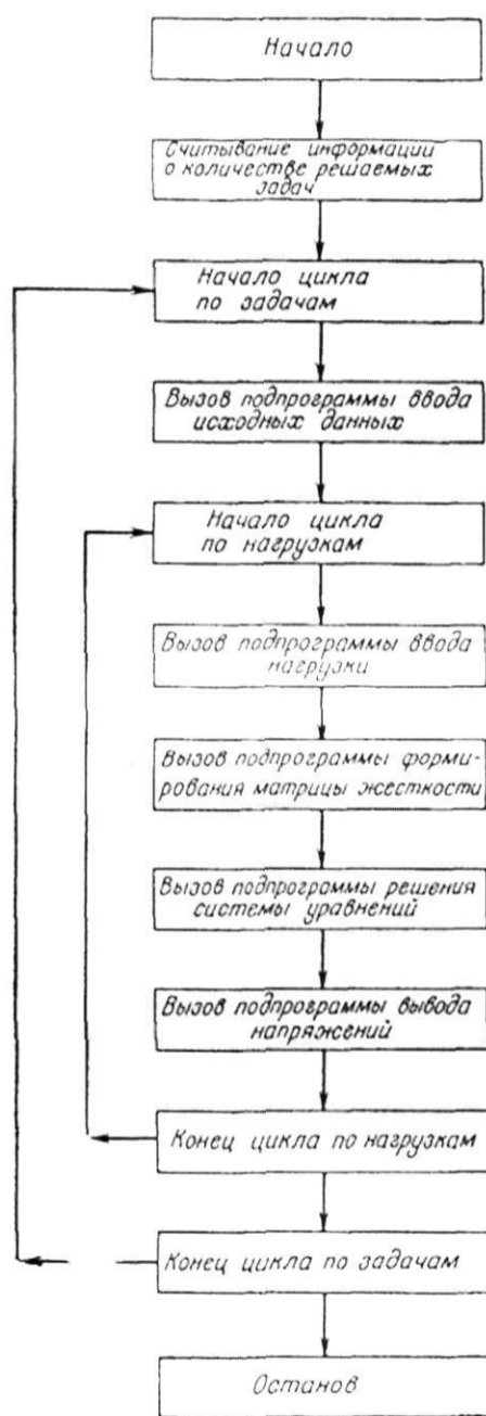
Рисунок 2.1 – Блок-схема программы, реализующей МКЭ
