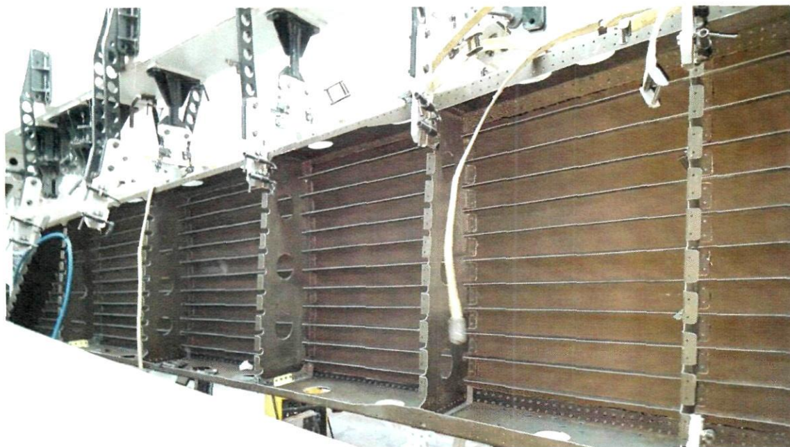
Рисунок 20 – Внутренний контур кессона кия, выполненного из КМ
