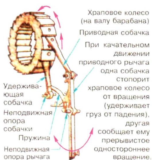
Рисунок 3 - Механизм свободного хода для грузоподъемного устройства
