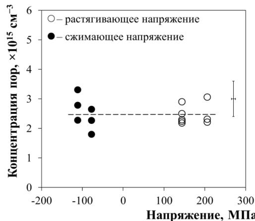
Рисунок 16 – Зависимость концентрации пор в стали марки 08X18Н10Т, облучённой до повреждающей дозы 36 сна при температуре 400 – 420 °С, от значений сжимающего и растягивающего напряжения
