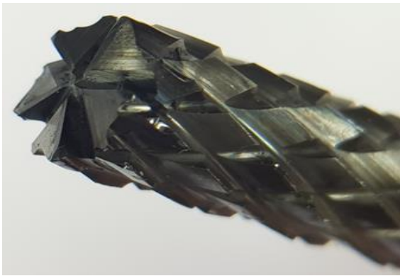
Рис. 4. Вид износа (сколы) керамического (а) и твердосплавного (б) инструмента
