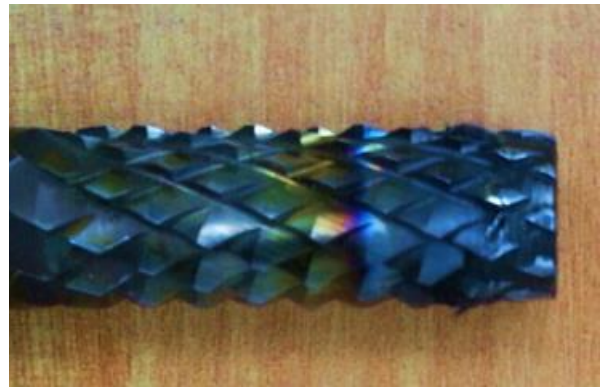
Рис. 4. Вид износа (сколы) керамического (а) и твердосплавного (б) инструмента
