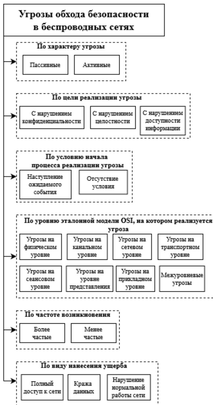
**Рис.1.** Классификация угроз в беспроводных сетях.
