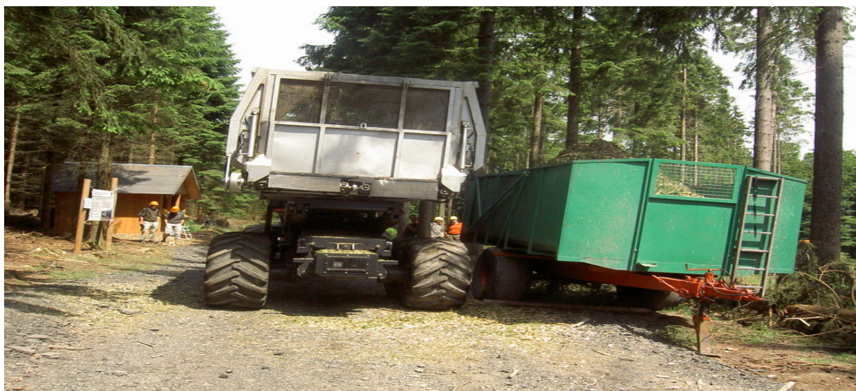
Рисунок 8 – Лесной комбайн с харвестерной головкой (доставка контейнера на погрузочный пункт)
