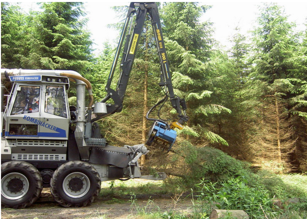
Рисунок 7 – Лесной комбайн с харвестерной головкой (приемное устройство)
