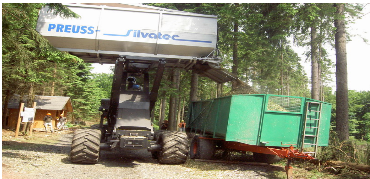
Рисунок 9 – Лесной комбайн с харвестерной головкой (разгрузка щепы)
