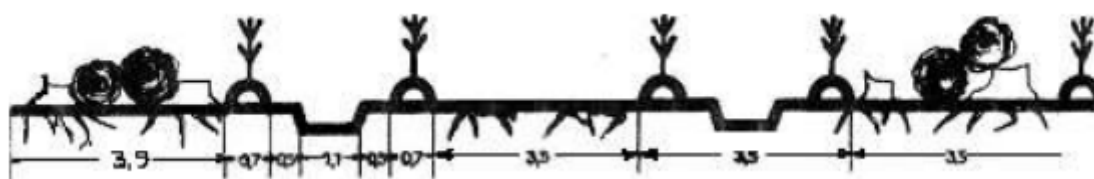
Рисунок 1 - Схема размещения лесокультурных полос при узкополосной корчевке пней (полоса с пнями, посадка саженцев, полоса для прохода техники, посадка саженцев, полоса с пнями). Расстояния даны в метрах
