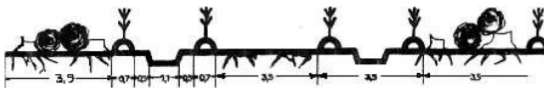
Рисунок 5 - Схема размещения лесокультурных полос при узкополосной корчевке пней (полоса с пнями, посадка саженцев, полоса для прохода техники, посадка саженцев, полоса с пнями). Расстояния даны в метрах
