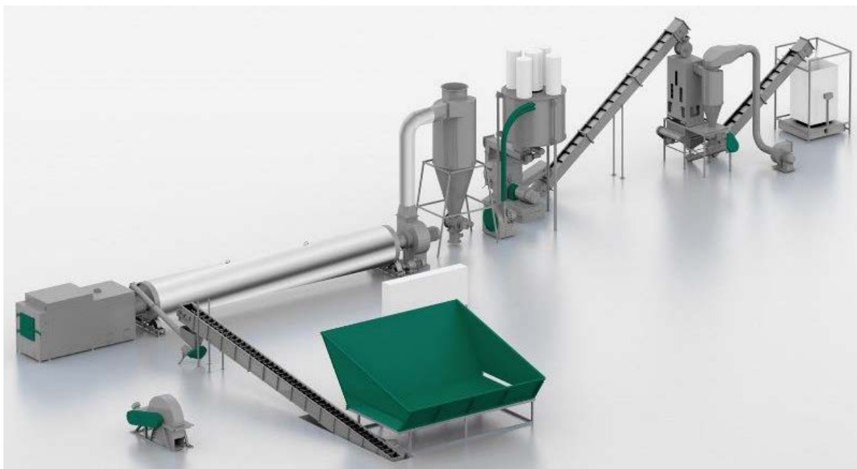
Рисунок 4 – Схема линии для производства древесных гранул (пеллет)
