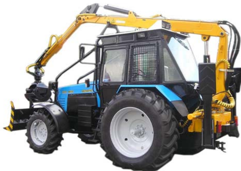
Рисунок 3 – Машина лесная погрузочно-транспортная Беларусь 1221МЛХ
