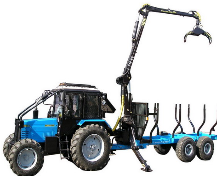
Рисунок 4 - Машина лесная погрузочно-транспортная Беларусь МПТ-461.1
