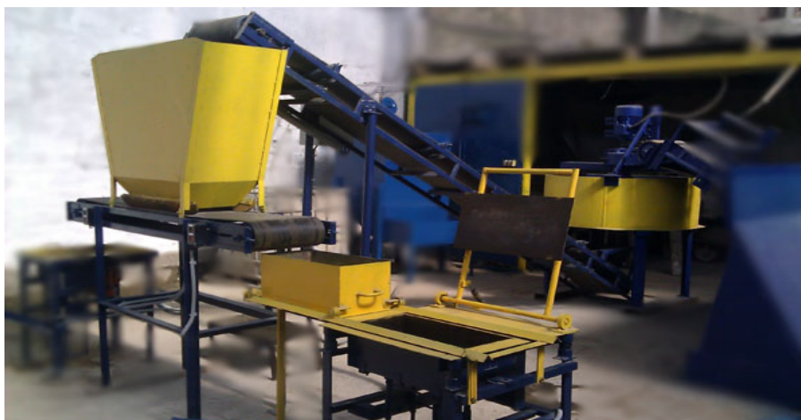
Рисунок 8 – Линия по производству арболита СГС-Л4
