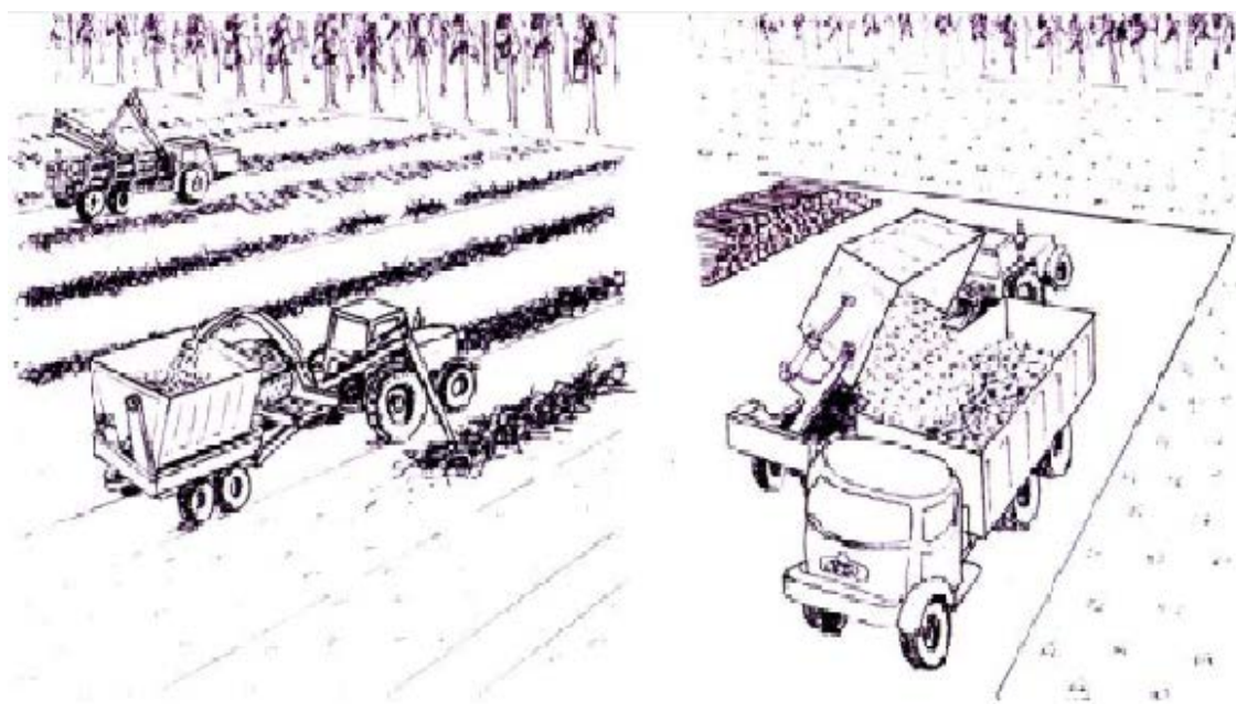
Рисунок 2 – Схема движения агрегатов при производстве щепы на лесосеке
