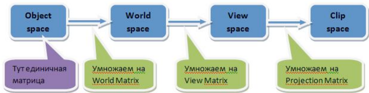
Схема 1. Преобразование вершины из пространства объекта в пространство усеченных координат.
