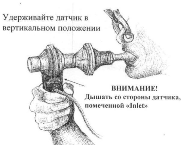
**Рис.10. Схема положения датчика для процедуры калибровки.**
