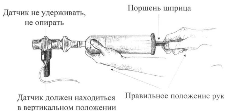
**Рис.8.Схема присоединения шприц-фильтра к датчику потока воздуха**
