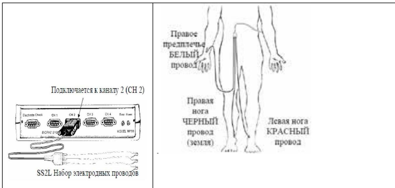
**Рис. 5. Схема подключения оборудования и расположения электродов**
