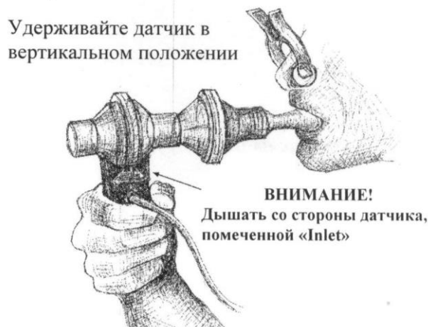
Рис.10. Схема положения датчика для процедуры калибровки.
