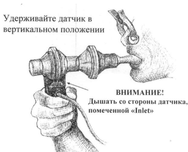
Рис.10. Схема положения датчика для процедуры калибровки.
