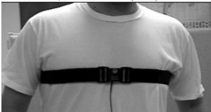
**Рис. 8 Расположение датчика SS5LB**
